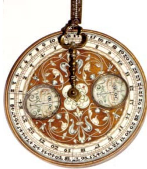
Abb.23 Doppelbussole um 1600, Durchmesser 24 cm – Ästhetik im Werkzeug eines Markscheiders.
